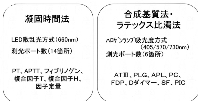
図2 測定原理 凝固時間法、合成基質法、ラテックス比濁法の3つの測定原理に対応している。 同時に20項目のランダムアクセスが可能である。
