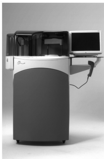
図1 コアプレスタ2000の外観 省スペース設計（設置面積約0.47m 2 ）のフロアタイプである。
