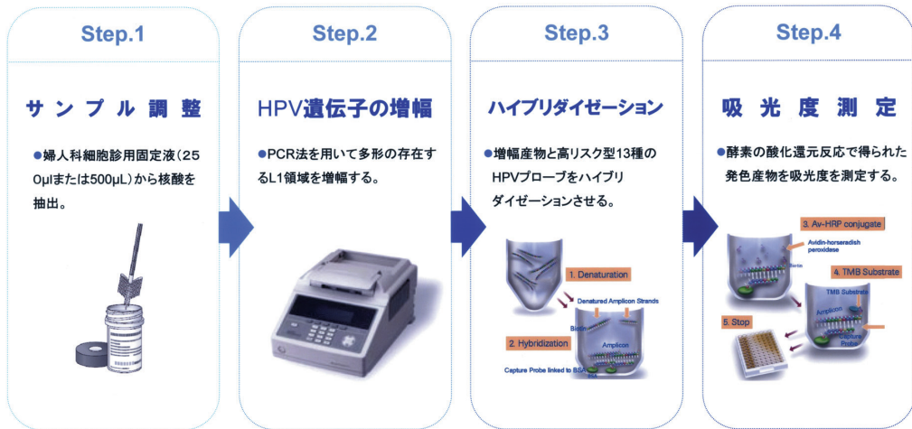
図1 アンプリコアHPVキットの測定原理
